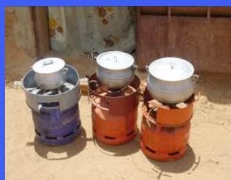
Foyer à gaz propane
